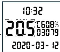
在正常运行界面下，依次按压“▲”、“▲”、“▼”、“□”键进入温度标定界面，温度值闪烁，再按一下“□”键，用“▲”、“▼”键调整大小，按“□”键确认，显示“YES”标定完成。
